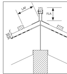
LAF = Lattenabstand zum Firstschnittpunkt (in mm)
